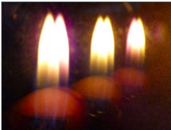
Abb. 4: Bei einer 3-fach-Wärmedämmverglasung sind 3 Flammenpaare zu erkennen: Die hintere Flamme des vorderen Flammenpaares sowie die vordere Flamme des hinteren Flammenpaares sind violett gefärbt. Das heißt, die vordere sowie hintere Glasscheibe sind beschichtet.
